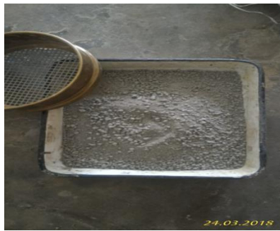
Fig. 5. Fly ash geopolymer sand
