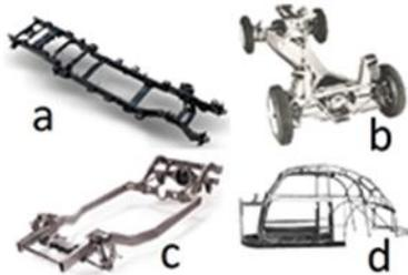
Fig. 1. (a) Ladder chassis, (b) Backbone chassis, (c) Perimeter Chassis, (d) Superleggera
