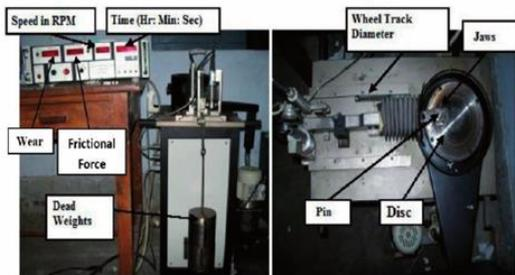
Fig. 4. Pin-On-Disc
