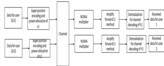
Fig. 2. Block diagram
