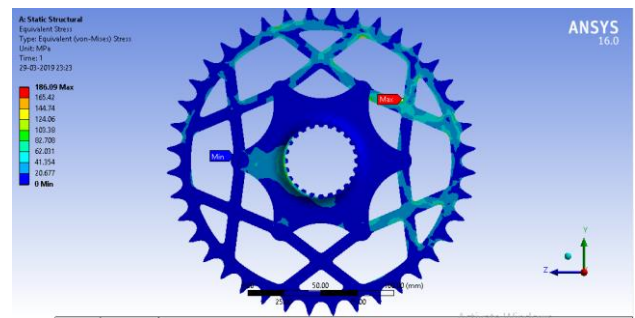
Fig. 9. Von misses stress plot
