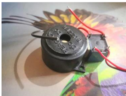
Fig. 7. Fire Alarm (Buzzer)
