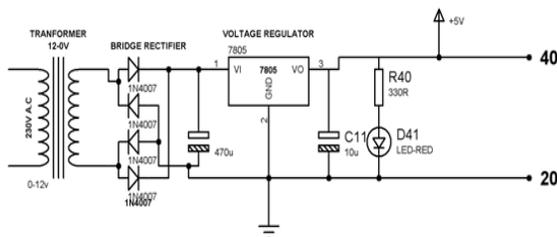
Fig. 3. Full wave bridge rectifier
