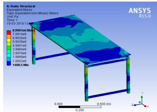
Fig. 15. Von-Mises Stress of 100kg
