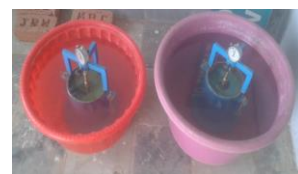
Fig. 17. Soaked CBR test
