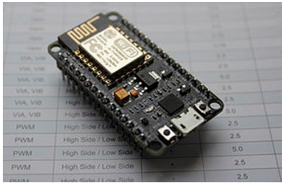
Fig. 2. ESP 8266 Wi-Fi module (Node MCU)
