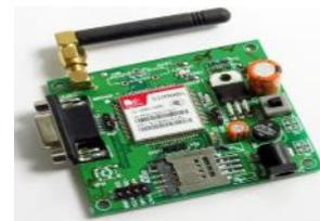
Fig. 6. GSM Sim 900A
