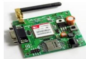
Fig. 6. GSM Sim 900A
