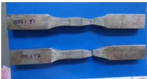
Fig. 7 (a). Tensile Test Specimens
