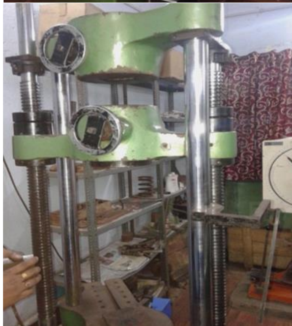
Fig. 6. Tensile tester (UTM)
