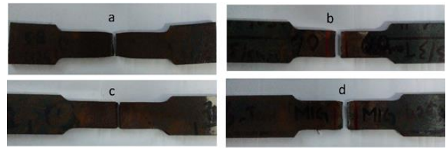
Fig. 3. Specimen of (a) Base plate (b) Arc Welding (c) TIG welding (d) MIG Welding
